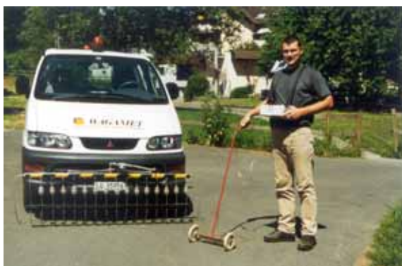
Netz-Dichtheitsprüfung mit Gasspür-Fahrzeug und Hand-Messteppich
